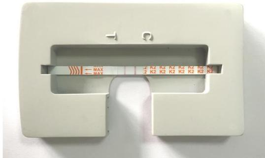
**Fig.16 La colocación de la tira de prueba en el cartucho**
