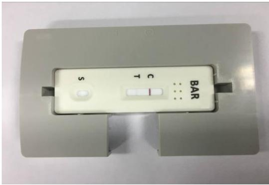
**Fig.17** La colocación del casete de prueba en el cartucho
